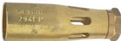
• Quemadores estándar con llamas de tipo pincel para todo tipo de aplicaciones de calentamiento suave de soldadura / pequeña • soldadura con plata alrededor de 615 ° C • Para la conexión a Sievert necktubes Pro • La presión recomendada para el trabajo 2 bar.
