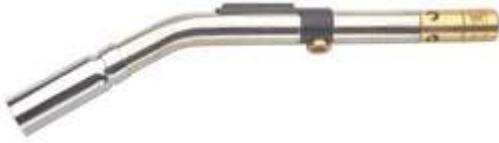
• Quemadores de llama ciclón son los quemadores más eficientes para la soldadura fuerte y blanda • La llama de rotación da una transferencia aun y todo el calor alrededor de la tubería • Presión de trabajo 2 bar.
